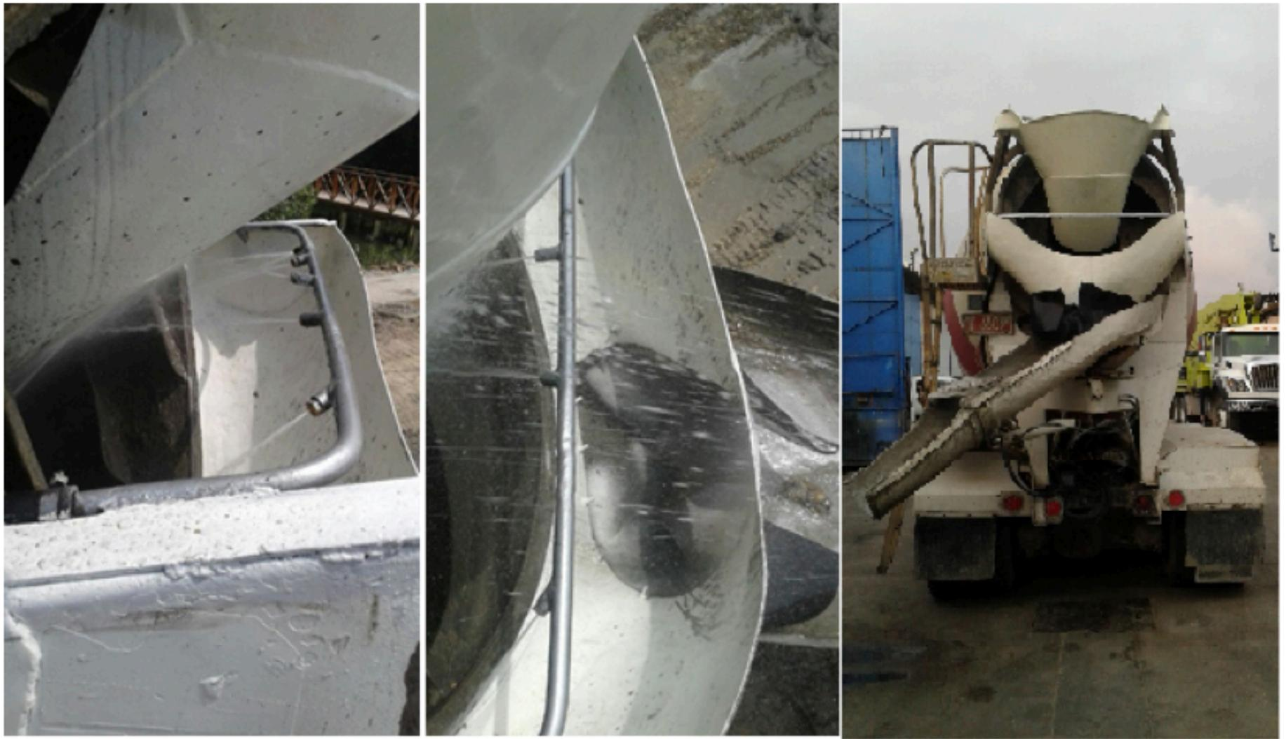
De manera experimental se calculó el tiempo que debe permanecer activado el sistema para garantizar la remoción del concreto en las zonas involucradas y el tiempo máximo dentro del cual se puede activar el sistema para que funcione, ya que si pasa de este tiempo el concreto se habrá fraguado demasiado y el sistema de lavado de lavado no sería capaz de removerlo. Estos datos pueden observarse en la tabla 5.
