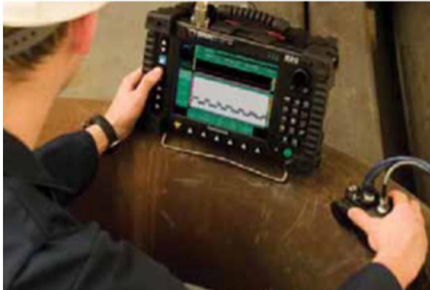
Figura 6. Medición por ultrasonido Fuente: («Tecnicontrol», s. f.)
